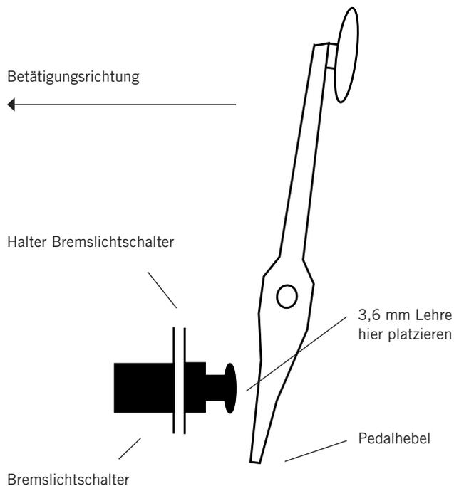
Im betätigten Zustand müssen nach spätestens 12 mm die Bremsleuchten angehen.
